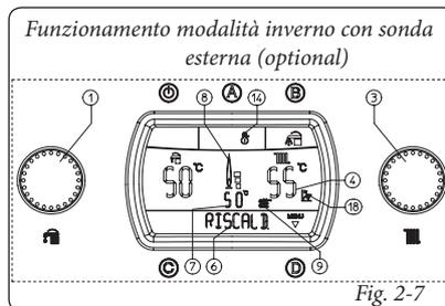
Da questo momento la caldaia funziona automaticamente. In assenza di richieste di calore (riscaldamento o produzione acqua calda sanitaria), la caldaia si porta in funzione "attesa" equivalente a caldaia alimentata senza presenza di fiamma.
